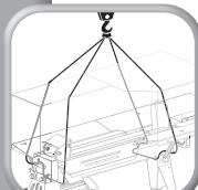
Spalter mit Riemen/Schleifen befestigen
