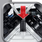
Öleinfüllstopfen wieder einsetzen
