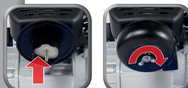
Ansaugfilter einsetzen, Abdeckung anschrauben (beidseitig)
