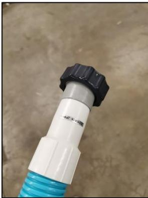
Nun die Adapter mit dem blauen Schlauch verbinden und mit dem Adapter an der Sandfilteranlage anbringen. Bei der Bürste selbst braucht es kein Adapter
