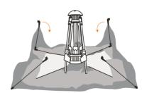
Lösen Sie die untere Verbindung an jedem Fussteil und falten Sie es zur Mitte hin zusammen.
