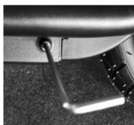
Verriegelungsposition des Batteriefachs
