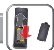
Batteriefach öffnen, Batterien austauschen
