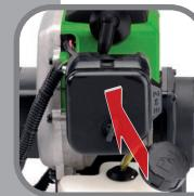
Filterabdeckung korrekt anbringen
