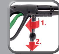
Hochdruckschlauch von Pistole entfernen
