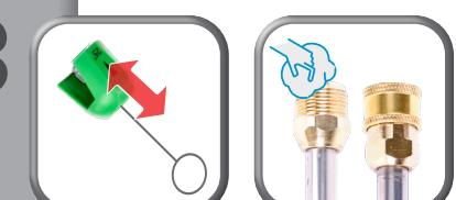
Ventile und Gewinde mit Draht und feuchtem Tuch reinigen
