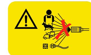
Mit dem Wasserstrahl nicht auf Menschen, Tiere, elektrische Geräte, Steckdosen oder das Gerät selbst zielen.
