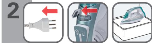
Gerät ausstecken, Dampfreulierung auf MIN, über Spülbecken halten
