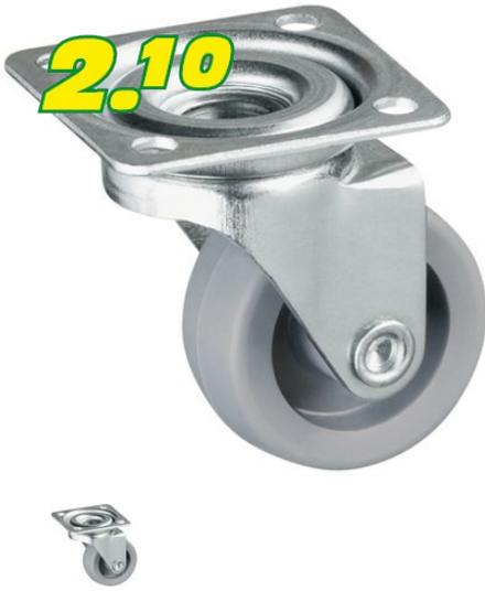
Avec palier lisse. Matériaux : polypropylène, acier galvanisé. Charge utile : 35 kg. Dimensions du plateau : 42 x 42 mm.
