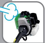
Gerät mit Druckluft (niedriger Druck) ausblasen
