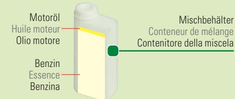
! Nur bleifreies Benzin und 2-Takt-Motoröl verwenden. Motoröl mit empfohlenem Mischverhältnis 100 : 1 nicht verwenden.
