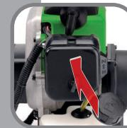
Filterabdeckung korrekt anbringen
