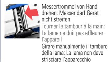
**!** Messertrommel von Hand drehen: Messer darf Gerät nicht streifen
