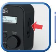
**Bei Bedarf: Gerät laden**
